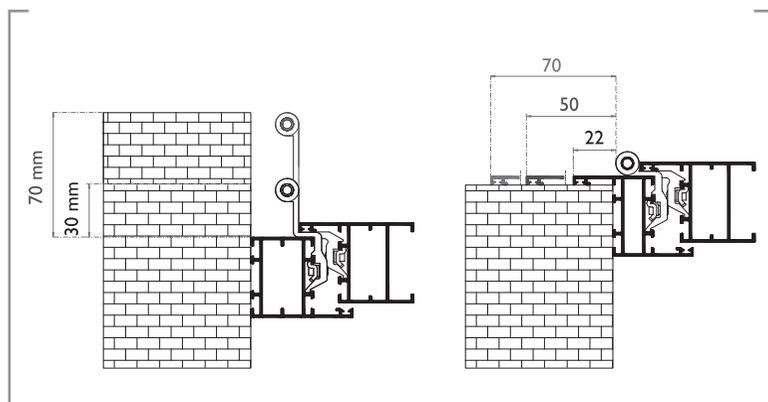
Sono disponibili diverse tipologie di telaio "Z" con Battuta di 22 mm, 50 mm e 70 mm. Il telaio a "L" senza Battuta con appositi accessori permette lo sbalzo dell'anta.
