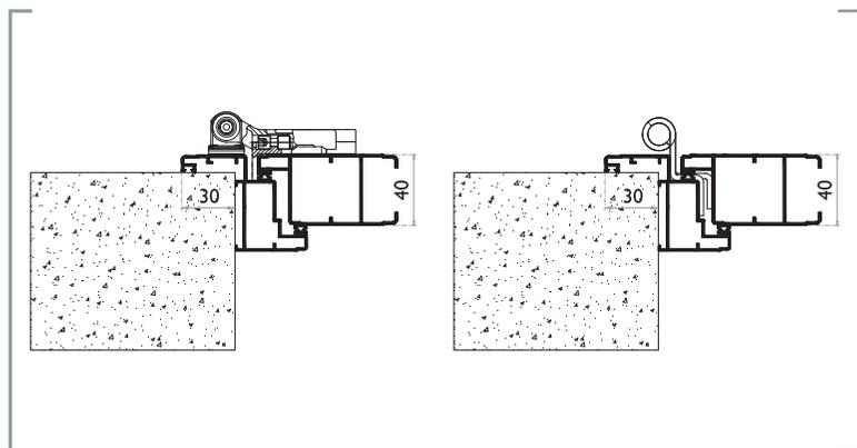
La persiana Rustica con il telaio arrotondato "Z" viene montata a filo muro esterno. Lo spessore della battuta è di 30 mm. Su questo tipo di persiana è possibile montare gli accessori di tipo Maico oppure cerniere nascoste.
