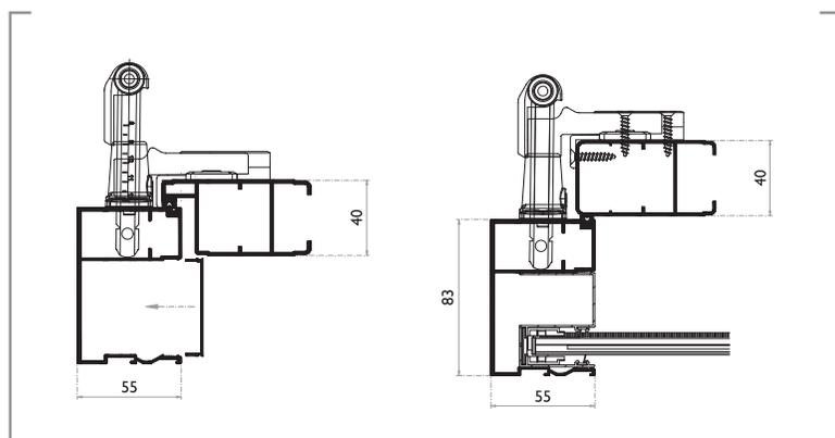
La persiana Monoblocco con telaio 55x83 è caratterizzata da uno spazio previsto per l'installazione della zanzariera. Il telaio 55x83 della persiana offre la possibilità di installare la zanzariera in un secondo momento.
