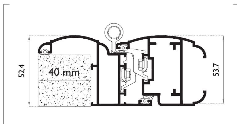
La persiana arrotondata con telaio è progettata per l'installazione sul filo esterno del muro con telaio "Z" battuta 40 mm.
