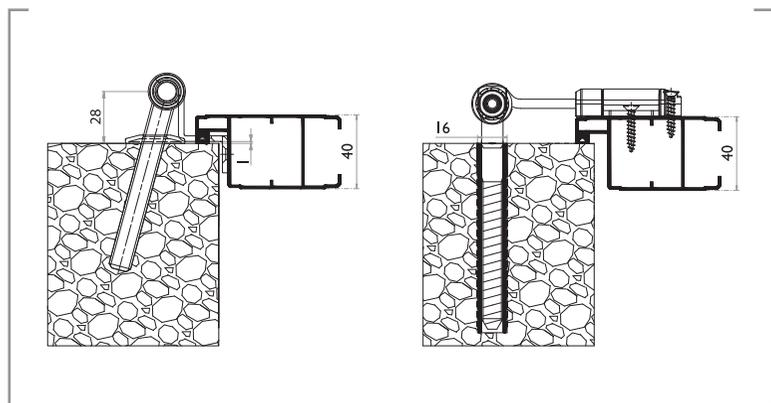
La persiana Antica viene montata direttamente a muro. La lunghezza della battuta è di 17 mm con inserimento di guarnizione.
